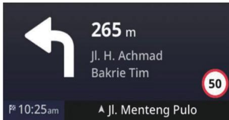
Im Modus “Turn-by-Turn (Abbiegehinweise)”: Betätigen Sie den Joystick nach links/rechts, um die Informationen am unteren Rand der Anzeige zwischen der verbleibenden Entfernung zum Ziel bzw. der geschätzten Zeit bis zur Ankunft und der aktuellen Position umzuschalten.
