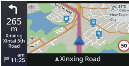
Wenn ein Befehl zur Auswahl eines Ziels verwendet wird, öffnet sich die Navigationsanzeige und zeigt die neue/aktualisierte Route.
