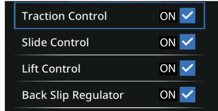
Mit diesem Menü können Sie die Stabilitätskontrollsysteme aktivieren/deaktivieren: “Traction Control” (TCS), “Slide Control” (SCS), “Lift Control” (LIF) und “Back Slip Regulator” (BSR). (Siehe Seite 3-1.)
